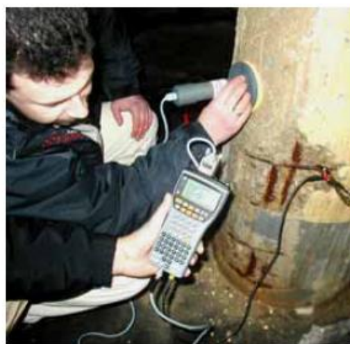
Prueba GalvaPulse en proceso para la actividad de corrosión en una columna altamente corroída.
