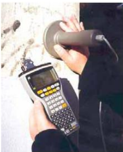
Actividad de corrosión siendo evaluada En la pared de un puente con el GalvaPulse .
